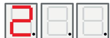
Le chiffre de gauche dans l'affichage LED est utilisé pour afficher l'élément de menu.
