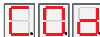
Le menu codé est verrouillé et ne peut être activé qu'en entrant le bon code. Lorsque vous déverrouillez ce menu, un drapeau est mis en place et ne peut être réinitialisé qu'en reprogrammant le firmware.
