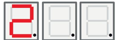
Het linker cijfer in de LED wordt gebruikt om het menu-item weer te geven.
