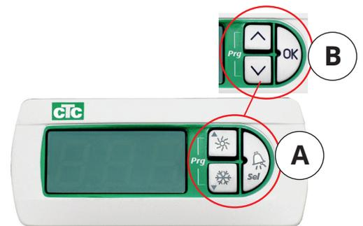
Durch Drücken und mindestens 5-sekündiges Halten der „OK“-Taste wird das Hauptmenü aufgerufen und die erste Position „1“ angezeigt. Die verschiedenen Hauptkategorien werden mit dem Suffix \*00 (1-4) angezeigt, d. h. das erste Menü wird mit „1“ bezeichnet, das zweite mit „2“ usw. Durch Drücken und mindestens 3-sekündiges Halten der „Auf“-Taste (Aufwärtspfeil) in einem Menü geht man einen Schritt nach oben in der Menüstruktur; in diesem Fall gelangt man zurück zur Start-Anzeige.
