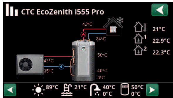
Huvudmenysidan för "Driftinfo" med luft/vatten värmepump CTC EcoAir ansluten. När pumparna är i drift så roterar även pumpsymbolerna på bilden.
