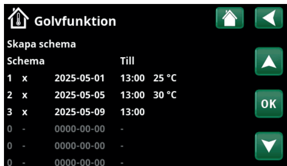
Meny: "Avancerat/Inställningar/Värmesystem/Värmesystem 1/ Golvfunktion".
